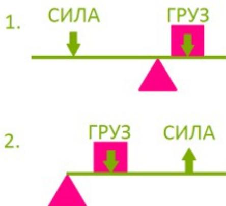
Различают два вида рычагов: У рычага 1 рода (рис. а) точка опоры располагается между линиями действия приложенных сил, а у рычага 2 рода (рис. б) она располагается по одну сторону от них.
