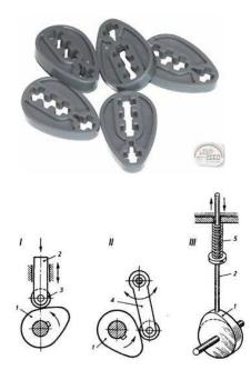
Достоинством кулачкового механизма является возможность движения подвижного звена и простота конструкции.
