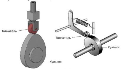
Типичный кулачок – некруглый диск, например, яйцевидной формы. При вращении кулачка толкатель движется вперед-назад (или вверх-вниз), расстояние от центра кулачка до точки его контакта с роликом толкателя уменьшается или увеличивается. Вращательное движение кулачка преобразуется в возвратно-поступательное или колебательное движение толкателя и связанных с ним деталей.
